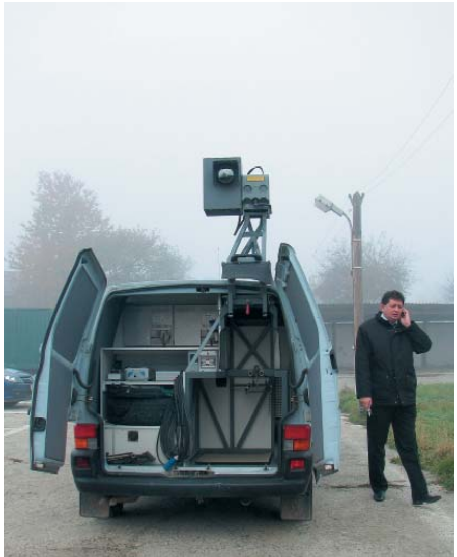
Maarajojen valvontaan rakennettu valvonta-auto varustettuna lämpökameralla.
